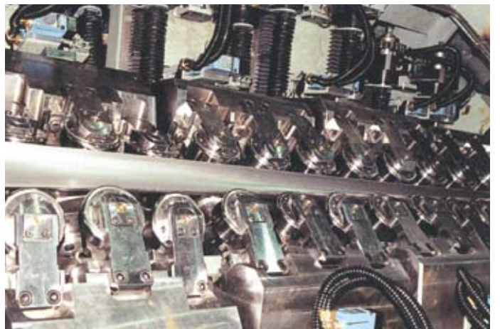
在进行钢管成形的CBR成形机
