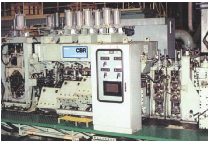
CBR成形机(小口径ERW不锈钢管机组)
