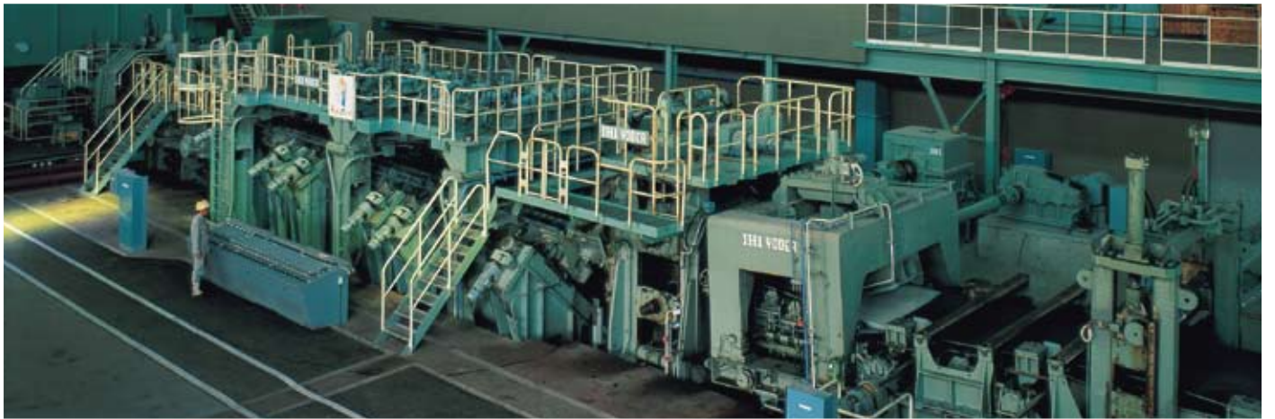
世界上最大口径/最大壁厚(26英寸)的钢管成形机(中口径ERW钢管机组)
